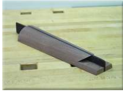
d) İki parça arasında kontra masif yapıştırılması ve sapa form verilmesi
