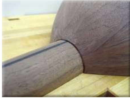
j) Sapın tekneye montajının kontrolü (tutkalsız)
