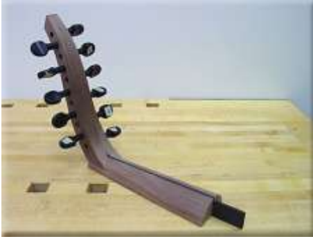
ı) Burguluk montajı kontrolü (tutkalsız)
