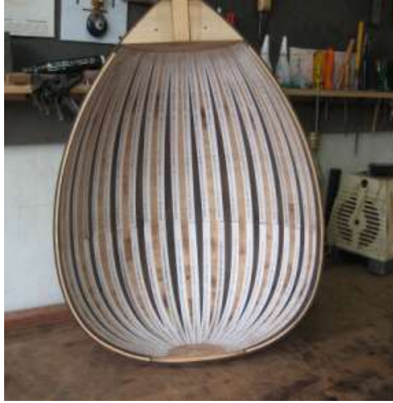
Resim 1.11: Bantlanmış ve tutkal sıvısıyla kaplanmış tekne ii
