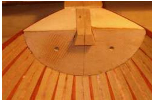
Resim 2.4: Sapın kırlangıç kuyruğu kızak-kanal geçmeli montajı
