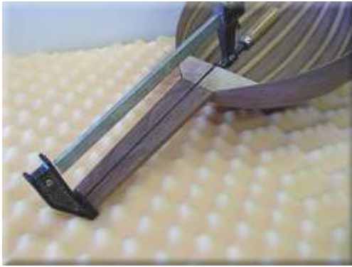
k) Sapın tekneye montajı (yapıştırma)
