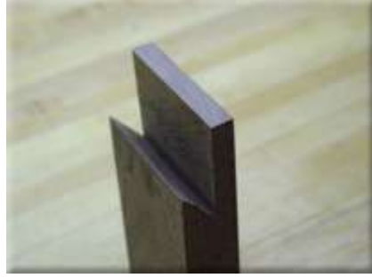
b) Sap burguluk açısının kesilmiş hâli
